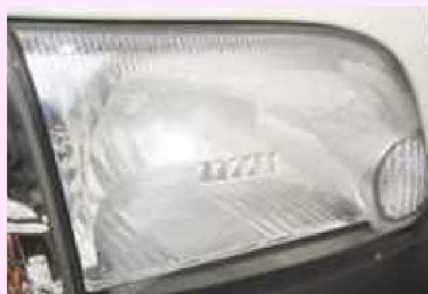
内部リフレクタの劣化
