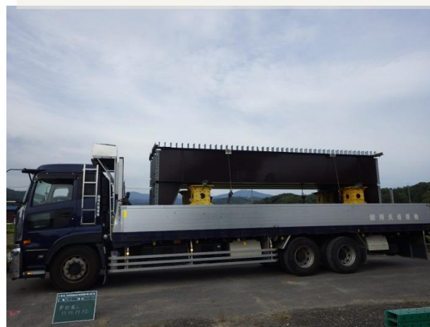
平車の積載状況
