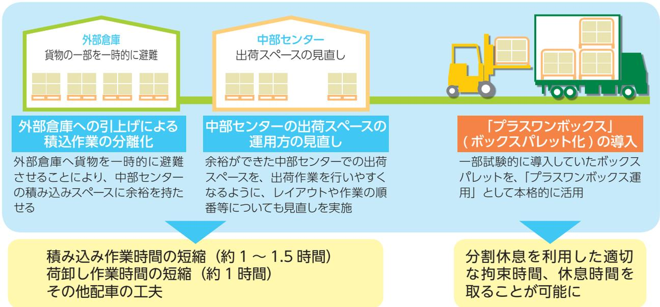
参考事例② パレット荷役による積み込み作業時間の削減
