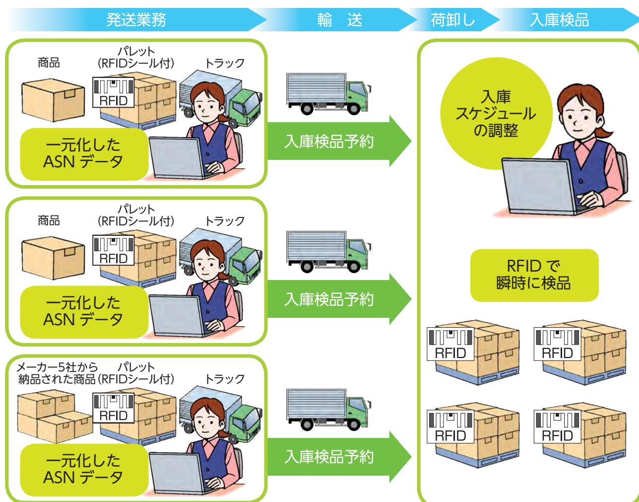
\* RFID … Radio Frequency Identification の略で、電波・電磁波を用いた無線通信で ID 情報を埋め込んだ IC チップ (RF タグ) から情報をやりとりする技術。物流の世界では在庫管理や検品作業、貨物の追跡などに利用される。
