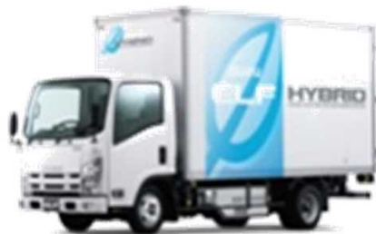
HVTトラック
