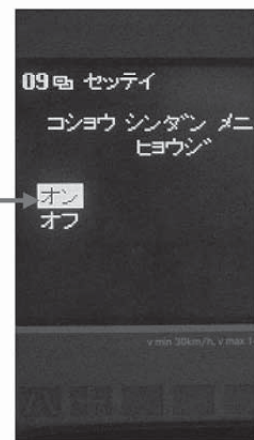
8: ハンドル右側の+ボタンを押して、表示 をオンに変更する。 これで故障診断メニューが表示できるよう になる。
