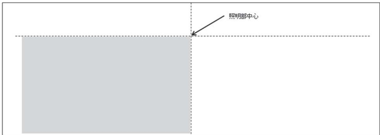
〔図2〕②(ア) 10mの距離において測定する場合の最高光度点の判定基準（前照灯の照明部中心の高さが1m以下の場合）
