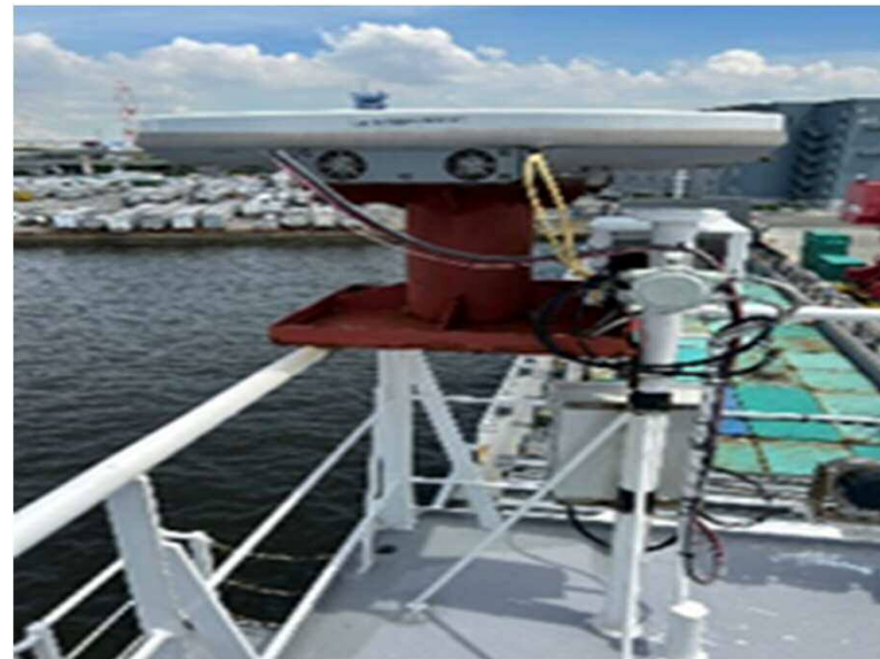
日本無線(株) 米国Kymeta Corporation社製 平面型アンテナ「Hawk u8」
