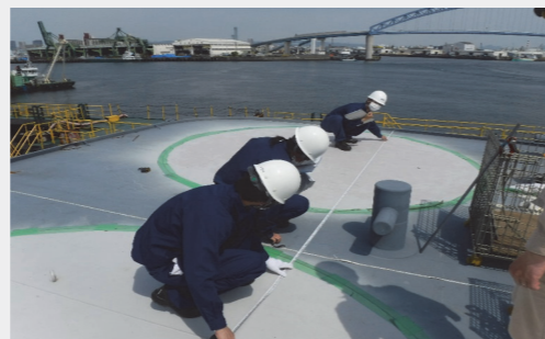
船舶測度官による総トン数の測度 (船の大きさを測る)を実施してい ます。
