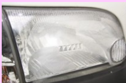
内部リフレクタの劣化
