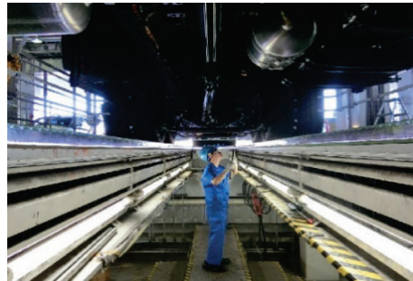
自動車検査官による車両下回りの検査
