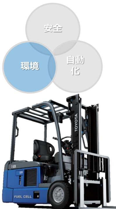
MIRAI(ミライ)の燃料電池セル搭載
