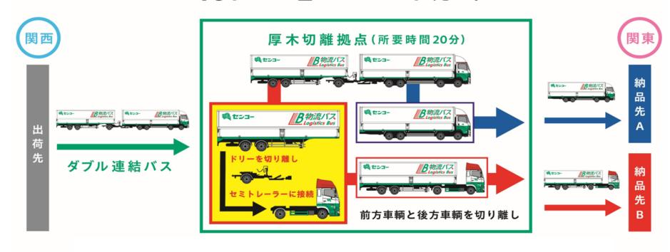
長距離幹線区間は連結してドライバー1人で運行、切り離し拠点から10トン車とセミトレーラーの2台に分かれ同時に納品先へ運行可能
