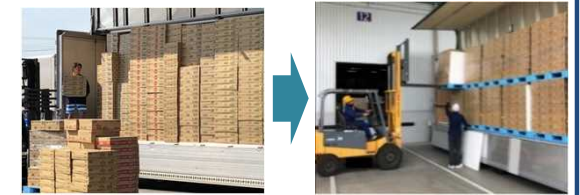
バラ積み・バラ降ろしによる非効率な荷役作業
