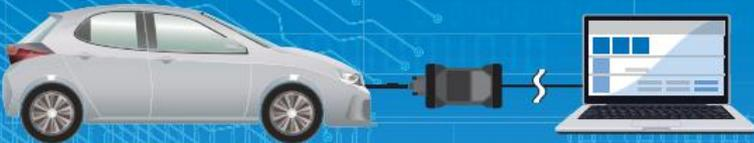
「OBD 検査」とは、自動運転技術などに用いられる電子制御装置が適切に機能しているかを確認する検査です。国の定める自動車検査（車検）の検査項目として、令和6年10月以降（輸入車は令和7年10月以降）に新たに追加されました。
