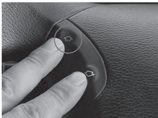
4: ハンドル左の上向矢印を押して「構成」のメニューへ入る。
