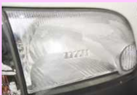
内部リフレクタの劣化
