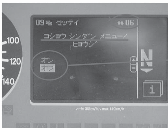
7: 設定/構成の中から 06 「故障診断メニューの表示」が表示される。
