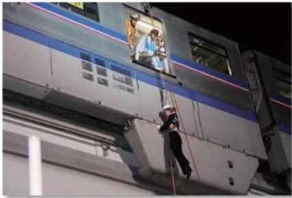
緩降機（スローダン）
