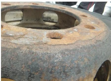
ディスク・ホイールのボルト穴や、ホイールの当たり面に、著しいさびによる劣化や損傷
