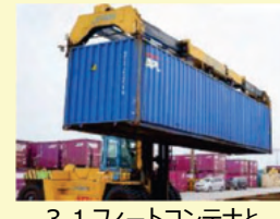
31フィートコンテナとトップリフター
