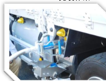
LNGタンクと充填ホース
