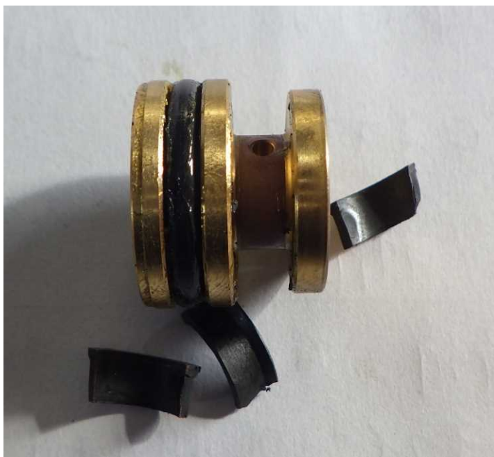
PCVのラバーバルブの劣化
