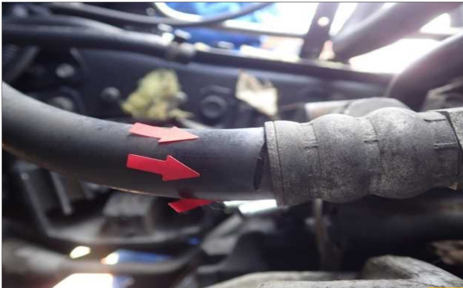
(図.2)事故車両のエアチャージホースの亀裂
