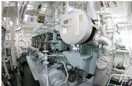
A重油は燃料加熱装置、燃料洗浄装置、焼却炉等が不要であり、また、機関室がクリーンになるため、船員作業が軽減される。
