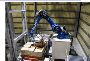
ピッキングロボット
