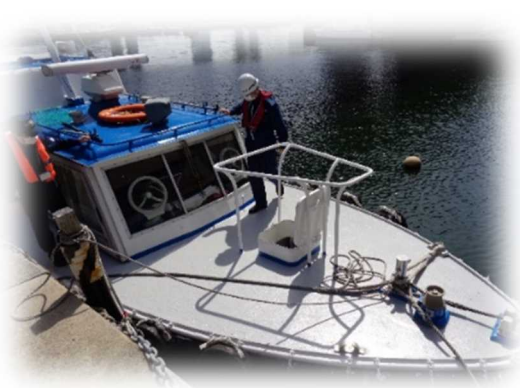
職員によるハッチカバーの安全点検
