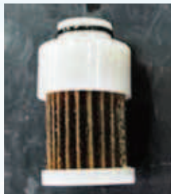
劣化した燃料フィルタ
