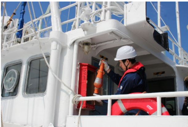
救命設備（自己点火灯）の点検
