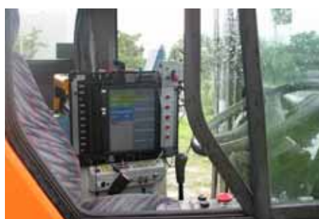
オンデマンドバスの車載器 ( 予約データがサーバから送信され、運転士に経路を指示 )
