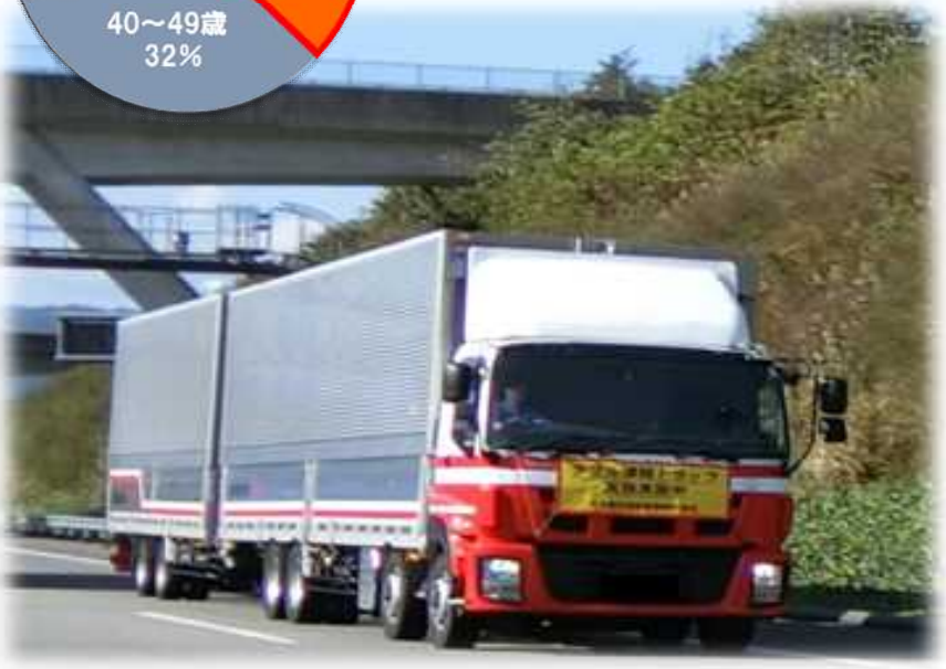
実験で走行中のダブル連結トラック
