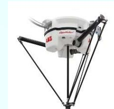
商品の包装工程において、箱詰めから封函まで自動で行うロボット
