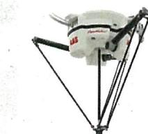
小さな作業領域で高出力かつ高精度で製品をピック&プレイスできるロボット
