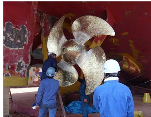
可変ピッチプロペラの検査の様子
