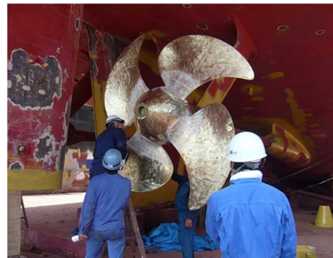
可変ピッチプロペラの検査の様子
