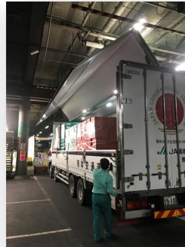
天井照明へ接触しないようウイングを全開させない様子
