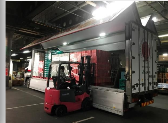
天井照明へ接触しないようウイングを全開させない様子
