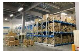
電動移動ラック 貯蔵保管機能強化
