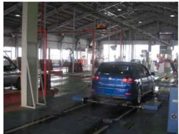
検査機器による判定
