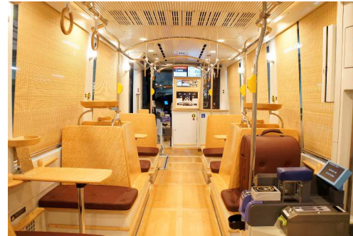
メープル材を使用した内装
