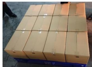
11型パレットへの 積付けパターン
