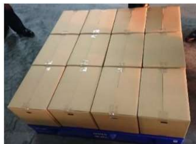
11型パレットへの 積付けパターン
