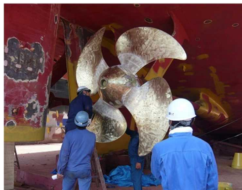
可変ピッチプロペラの検査の様子
