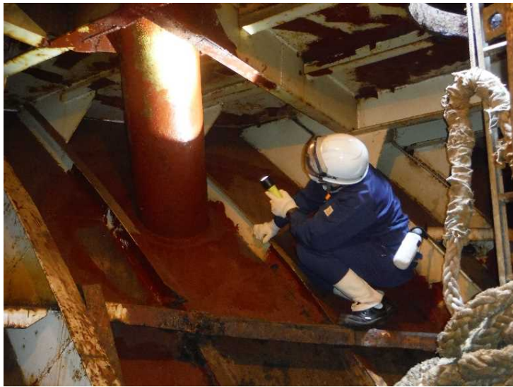
錨鎖孔(ホースパイプ)の検査
