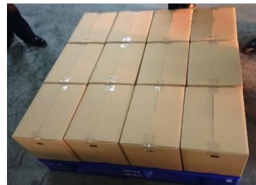
11型パレットへの 積付けパターン
