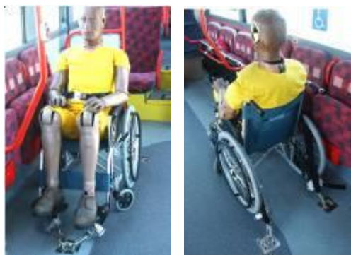
3点ベルト式車いす固定装置 (2点式シートベルトの装着も必要)
