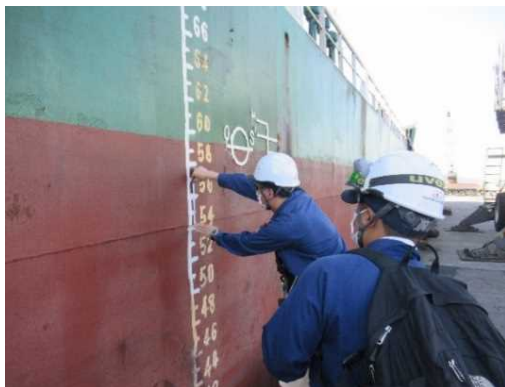
満載喫水線等の外観検査
