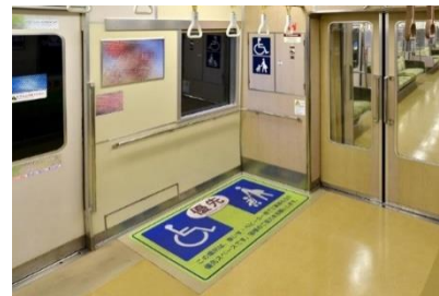
鉄道：車いすスペースの表示
