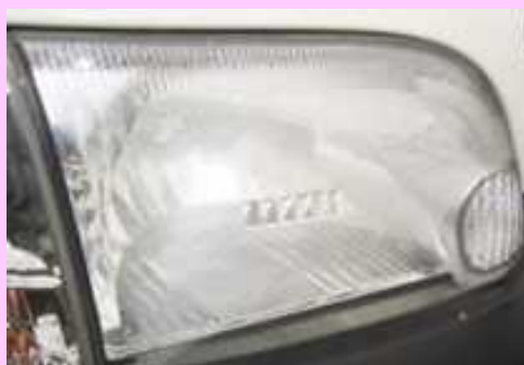
内部リフレクタの劣化
