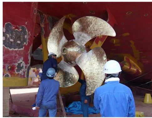
可変ピッチプロペラの検査の様子
