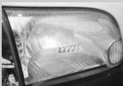
内部リフレクタの劣化
